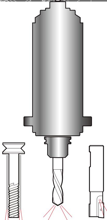
中心出油，耗油量低，該系統是將霧化的潤滑液通過加工機，穿過主軸的管道或數控車床中的管道，輸送霧化的潤滑液。
